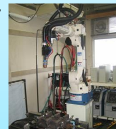
溶接ロボット
