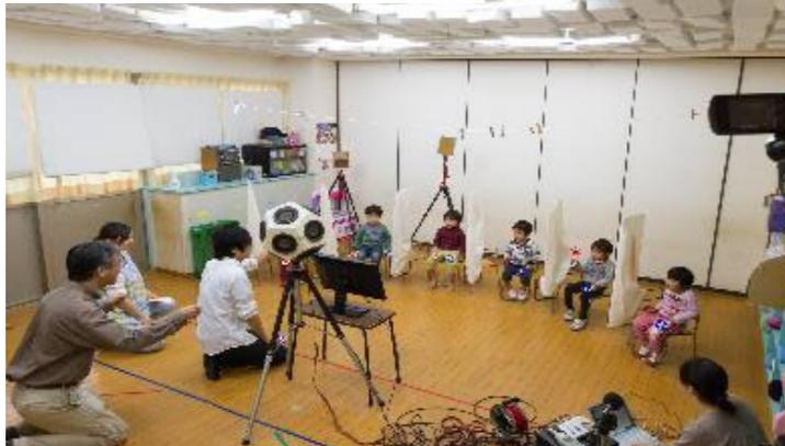
天井に吸音材を設置した保育室で園児への残響の影響をみる実験
