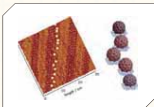
高次フラレンと白金ポルフィリンの超分子構造のナノレベル可視化
