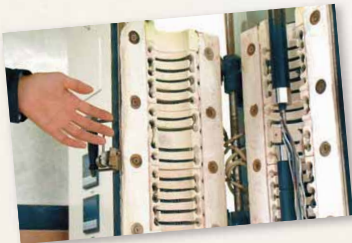
クリープ試験機。1200℃まで加熱可能ですが、通常は650℃で使用しています。
