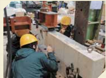
鉄筋コンクリート梁の載荷試験
