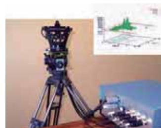
超音波アレイセンサと位置測定結果
