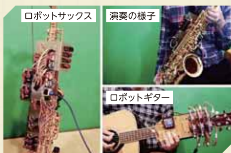
楽器演奏支援ロボット(ロボットの運指と、利用者の吹いたり弦を弾いたり操作で、好きな曲を簡単に演奏)
