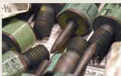
クリープ試験後の破断した試験片
