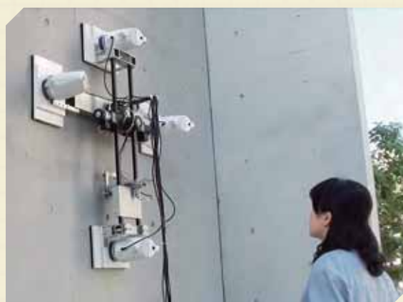
橋梁の橋脚や構造物の壁面を登はんして検査する装置の開発
