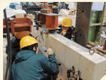
鉄筋コンクリート梁の載荷試験
