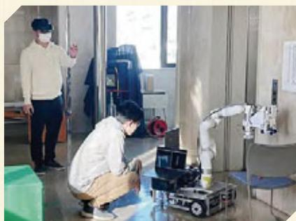
MRを用いたアシストロボットのピッキング
