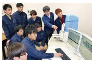
材料工学実験(走査型電子顕微鏡による金属組織の観察)
