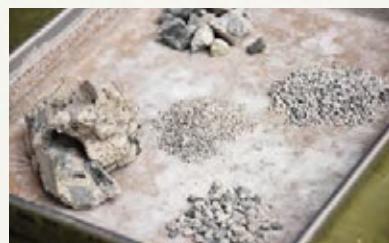
高度骨材再生処理によって粒度別に分離されたコンクリート
