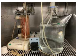
嫌気性アンモニア酸化 (ANAMMOX) 細菌の実験装置。ANAMMOX細菌は水中から窒素を除去する能力を持っています。
