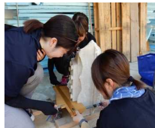
ギリシア古代都市ペラの調査風景 真弧(マコ)を用いて軒部材の断面形状を計測している様子
