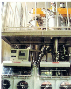
熊本大学で開発した急速凝固用クロースドP/Mプロセスングシステム
