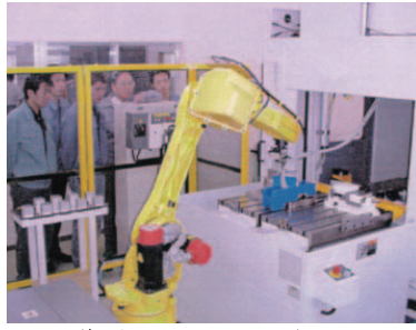
▲ロボットによるマシニングセンタへの工作物の自動段取り工程
