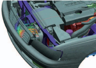
▲数値流体力学によるエンジンルーム内流れの数値シミュレーション
