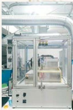
写真上： 高精度ディスプレイで精密な上部電極を作成 写真左： 圧電デバイス作製時に使用する自動スプレー装置
