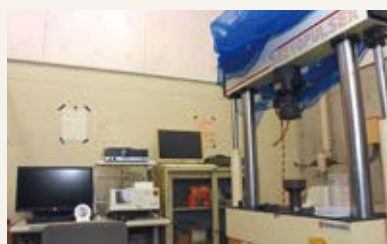
引張圧縮や各種波形の疲労試験が可能な材料強度試験装置
