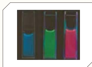
厚さ1nmのシート形状をもつ酸化物ナノシート発光材料
