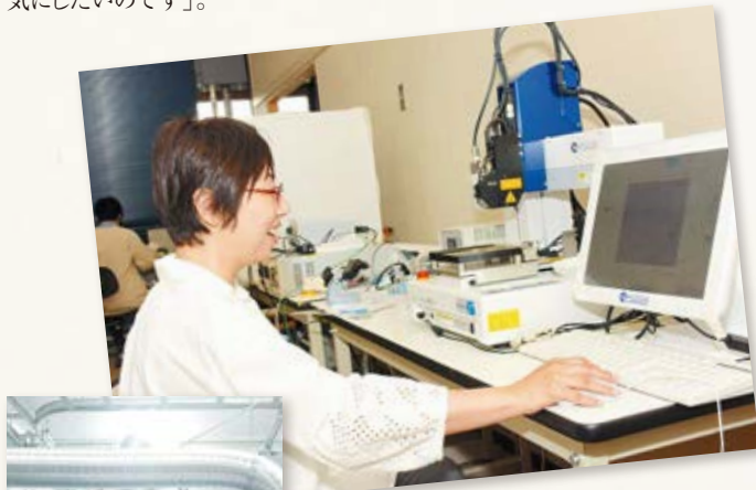
写真上： 高精度ディスプレイで精密な上部電極を作成 写真左： 圧電デバイス作製時に使用する自動スプレー装置
