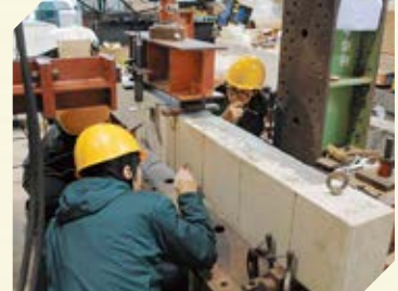
鉄筋コンクリート梁の載荷試験
