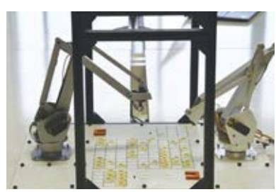
画像認識・ロボット制御を用いた将棋ロボット
