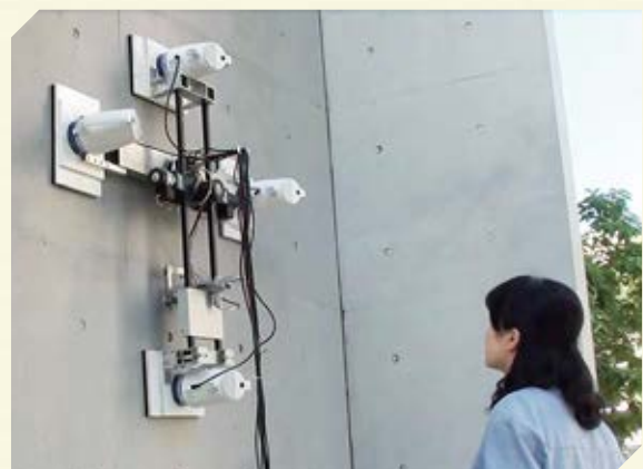
橋梁の橋脚や構造物の壁面を登はんにして検査する装置の開発
