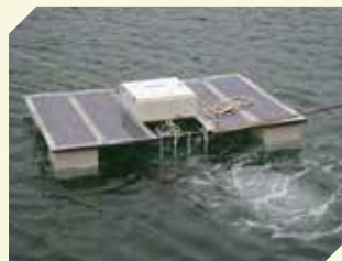
太陽電池でマイクロバブルを作り海水を浄化
