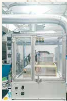
写真上： 高精度ディスペンサーで精密な上部電極を作成 写真左： 圧電デバイス作製時に使用する自動スプレー装置
