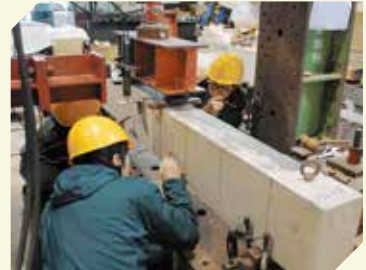
鉄筋コンクリート梁の載荷試験
