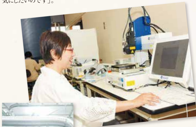
写真上： 高精度ディスペンサーで精密な上部電極を作成 写真左： 圧電デバイス作製時に使用する自動スプレー装置
