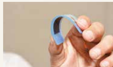
折り曲げできる圧電デバイス
