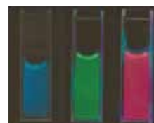
厚さ1nmのシート形状をもつ酸化物ナノシート発光材料
