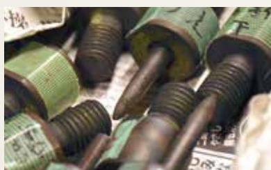
クリープ試験後の破断した試験片
