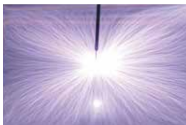
高繰り返し高電圧パルスパワーによる水面プラズマ
