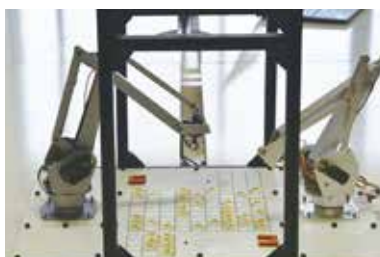
画像認識・ロボット制御を用いた将棋ロボット
