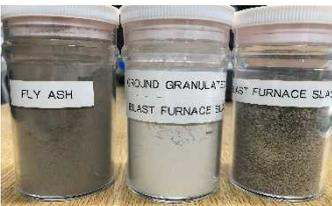
火力発電所からのフライアッシュと製鉄所からの高炉スラグ。化学反応によって密化し、コンクリートの耐久性を高めます。
