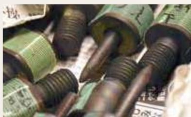
クリープ試験後の破断した試験片
