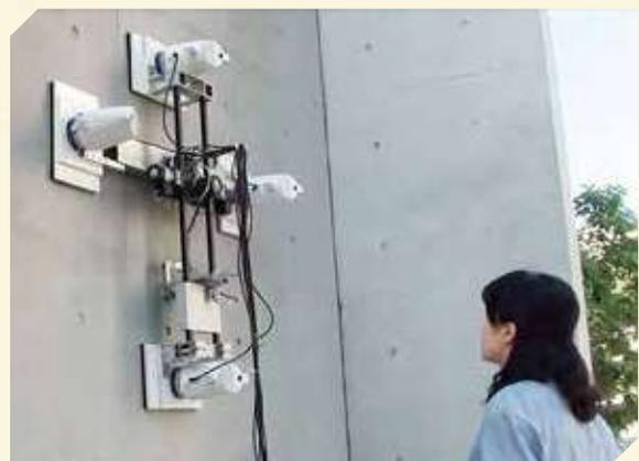
橋梁の橋脚や構造物の壁面を登はんにして検査する装置の開発
