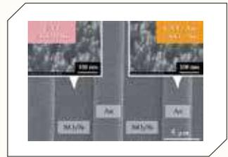
ナノサイズの高吸着アンテナがくし形電極(5μmギャップ、50本/くし歯)に密集したデバイス
