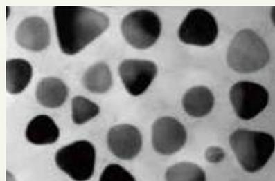
銀ナノプレートの電子顕微鏡写真
