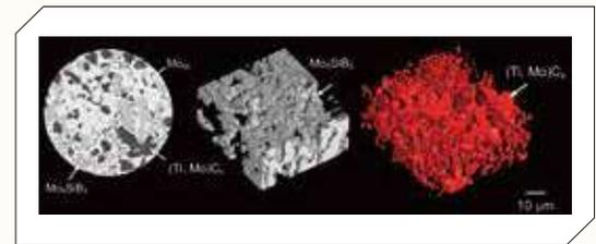
次世代航空機ジェットエンジン用超高温材料として開発が進められているMo<sub>5</sub>SiB<sub>2</sub>C合金を2次元走査型電子顕微鏡像と同視野からMo<sub>5</sub>SiB<sub>2</sub>相のみを抽出した3次元像
