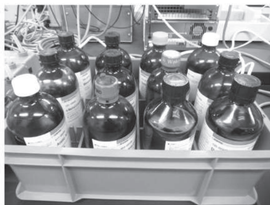
地震時に瓶同士の接触を防ぎます
