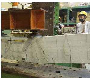
鉄筋コンクリート梁の曲げ載荷実験 構造部材である鉄筋コンクリート梁の強さを曲げ載荷実験により調べています。
